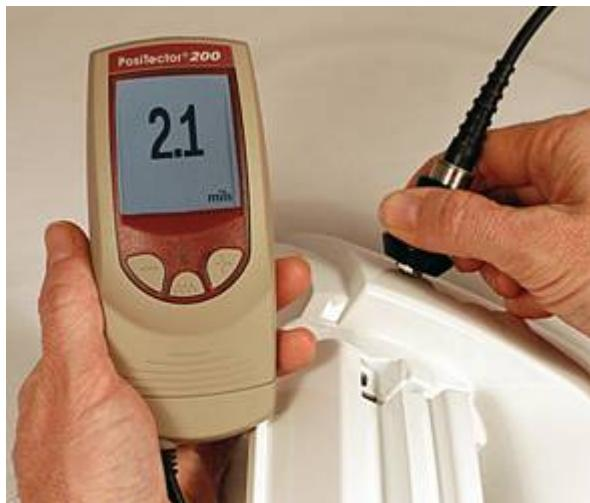
Применение ультразвуковых толщиномеров покрытий является легким и наглядным, как применение привычных магнитных толщиномеров покрытий. Метод измерения – простой и неразрушающий.
